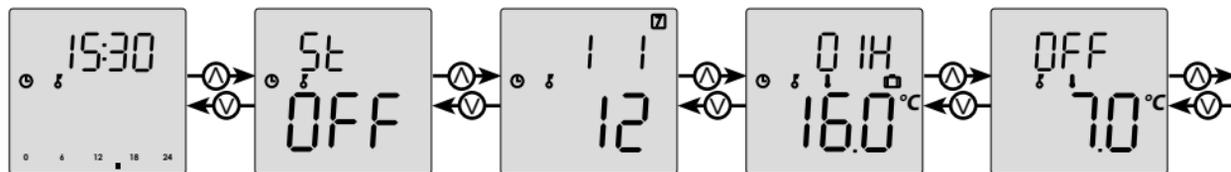
nastavení času - nejprve se nastavují hodiny a potom minuty - při potvrzení hodnoty se nuluje skrytý časovač sekund
