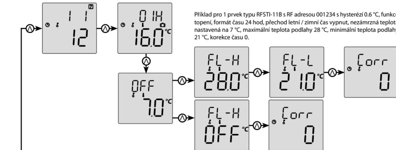
Příklad pro 1 prvek typu RFSTI-11B s RF adresou 001234 s hysterézí 0.6 °C, funkce topení, formát času 24 hod, přechod letní / zimní čas vypnut, nezámrzná teplota nastavená na 7 °C, maximální teplota podlahy 28 °C, minimální teplota podlahy 21 °C, korekce času 0.
