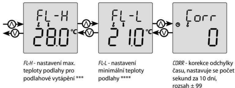
\*\*\* *OFF* - funkce podlahového vytápění vypnuta, je ovládán prvek (prvky) typu RFSA-6x. Rozsah 20 - 35 °C, funkce podlahového vytápění zapnuta, je ovládán prvek (prvky) typu RFSTI-11B (s datem výroby od 03/2013).
